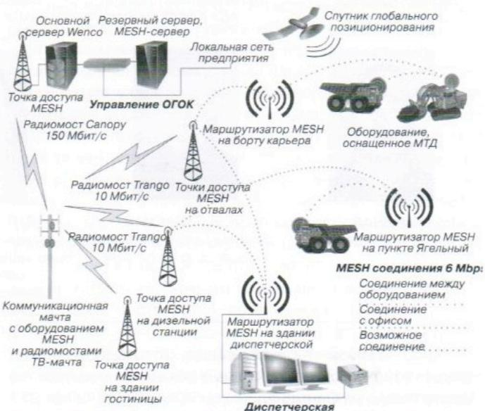
Рис. 2. Многоузловая широкополосная система коммуникаций на базе архитектуры MESH
