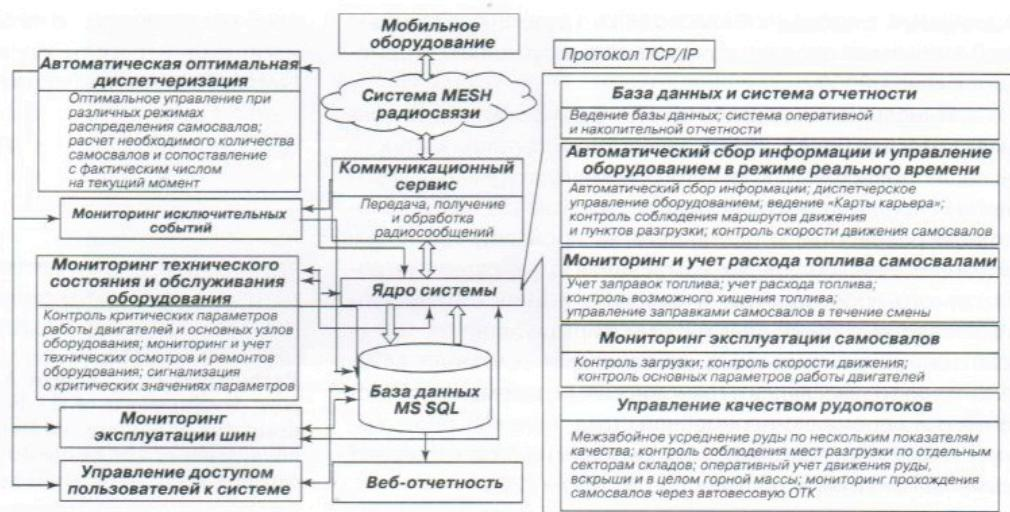
Рис. 1. Функциональная структура АСУ ГТК
